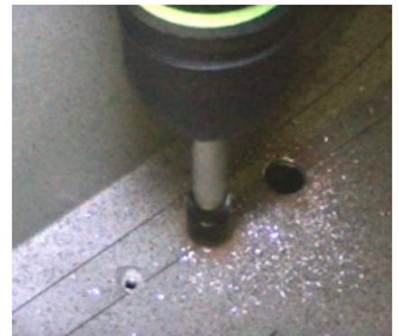
Die meisten Karosseriebleche an einem Oldtimer sind im Punkt-Naht Verfahren geschweißt. Will man solche Bleche lösen, ist es am besten die Schweiß-Punkte auszubohren. Für diesen Zweck gibt es besondere Bohrfräser, mit denen sich die Naht gut trennen lässt.
