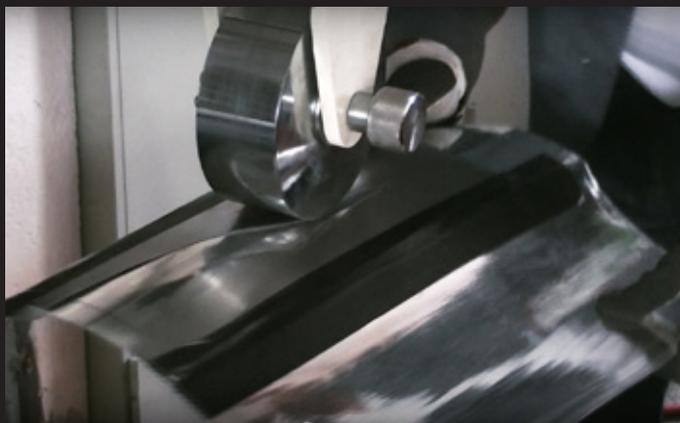
Blechschablone und Blech werden an der Rollenstreckmaschine bearbeitet
