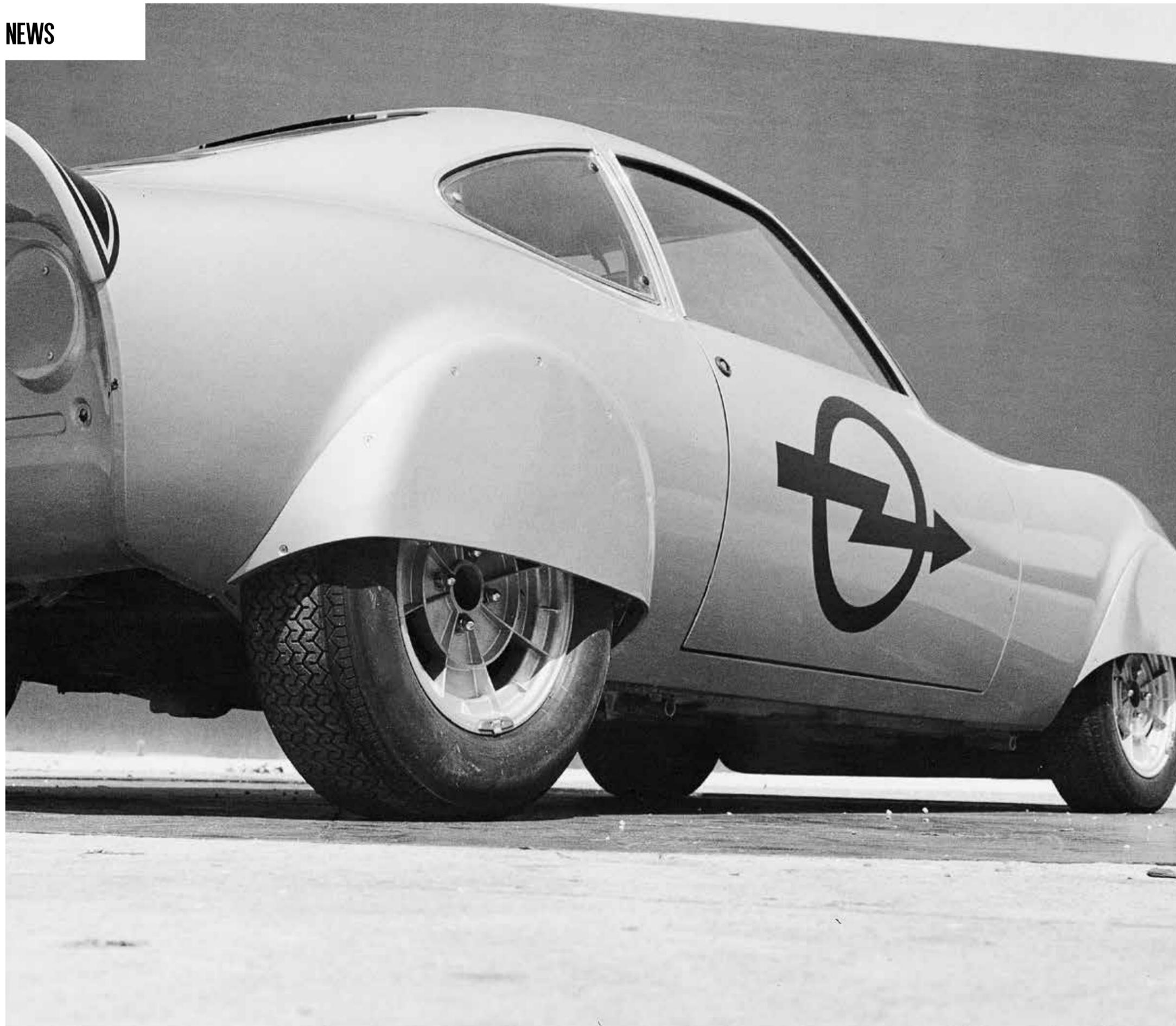
Auch an der Karosserie nimmt von Opel entscheidende Modifikationen vor: Alle Luftein- und -auslässe an der Fahrzeugfront werden verschlossen. Den Opel GT-typischen Vergaserbuckel auf der Motorhaube sucht man vergebens, stattdessen ist die Haube für eine bessere Aerodynamik komplett flach. Darüber hinaus werden die Stoßstangen, Rückspiegel und Türgriffe entfernt sowie der Motor- und Innenraum für den Einbau des Elektroantriebs freigeräumt.
