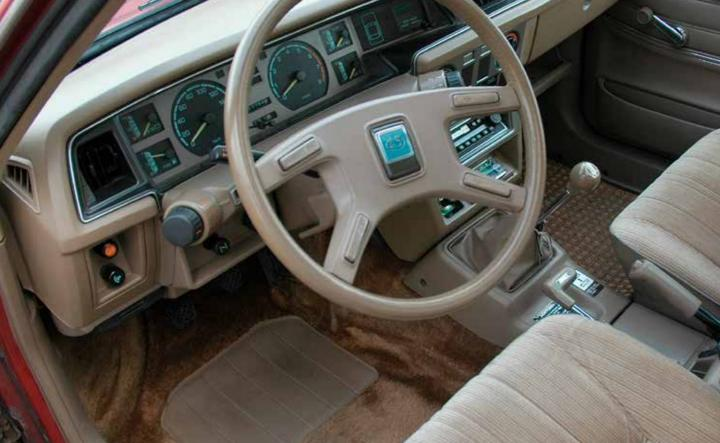
Gemein war allen Versionen das außergewöhnliche Antriebskonzept: Neben einem 1,8-Liter-Boxermotor, der 59 kW/80 PS und 135 Nm Drehmoment entwickelte, verfügte der Subaru 1800 4WD über einen zuschaltbaren Allradantrieb. Aktiviert wurde die Kraft der vier Räder durch Ziehen am entsprechenden Wählhebel zwischen den Vordersitzen.
