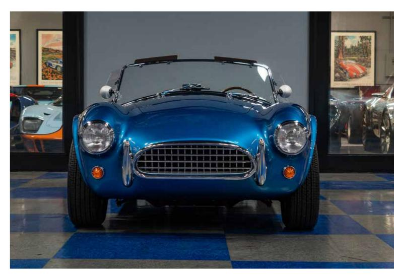
Der in Shelby Guardsman Blue lackierte MKII verfügt über eine vernickelte und verchromte Messing-Windschutzscheibe sowie einen kompletten Satz Chromstoßstangen. Scheinwerfer, Blinker und der Aluminiumgrill im Originalstil vervollständigen das äußere Erscheinungsbild. Das von BluePrint Engines gebaute Triebwerk mit 306 Kubikzentimeter Hubraum leistet 388 PS und ist mit einem Tremec T-5 5-Gang-Schaltgetriebe kombiniert.
