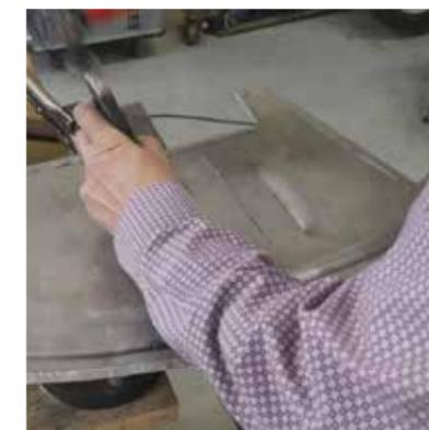
Mit einem Stempel wird die Sicke noch etwas in Form getrieben. Als Unterlage dienen zwei mit Abstand eingespannte L-Profile. Mit einem flachen Amboss und einem Treiblöffel wird die Sicke noch etwas in Formgebracht. Zum Abschluss wird die Sicke noch auf einem runden T-Amboss geglättet.
