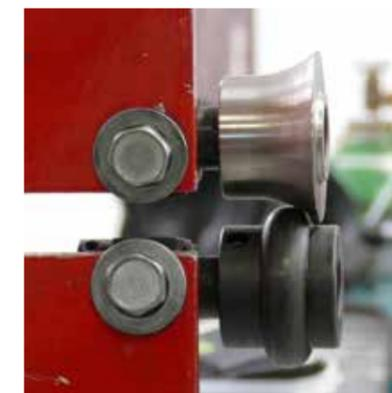
Die untere Rolle grenzt auf der Innenseite an die vorgetrennte Sickenöffnung. Nun wird das Blech vorwärts durch die Sickenrollen geführt. Am Ende werden die Rollen noch einmal etwas nachgespannt und das Blech noch einmal rückwärts durch die Rollen geführt. Dadurch ist die Luftsicke erhaben geformt.
