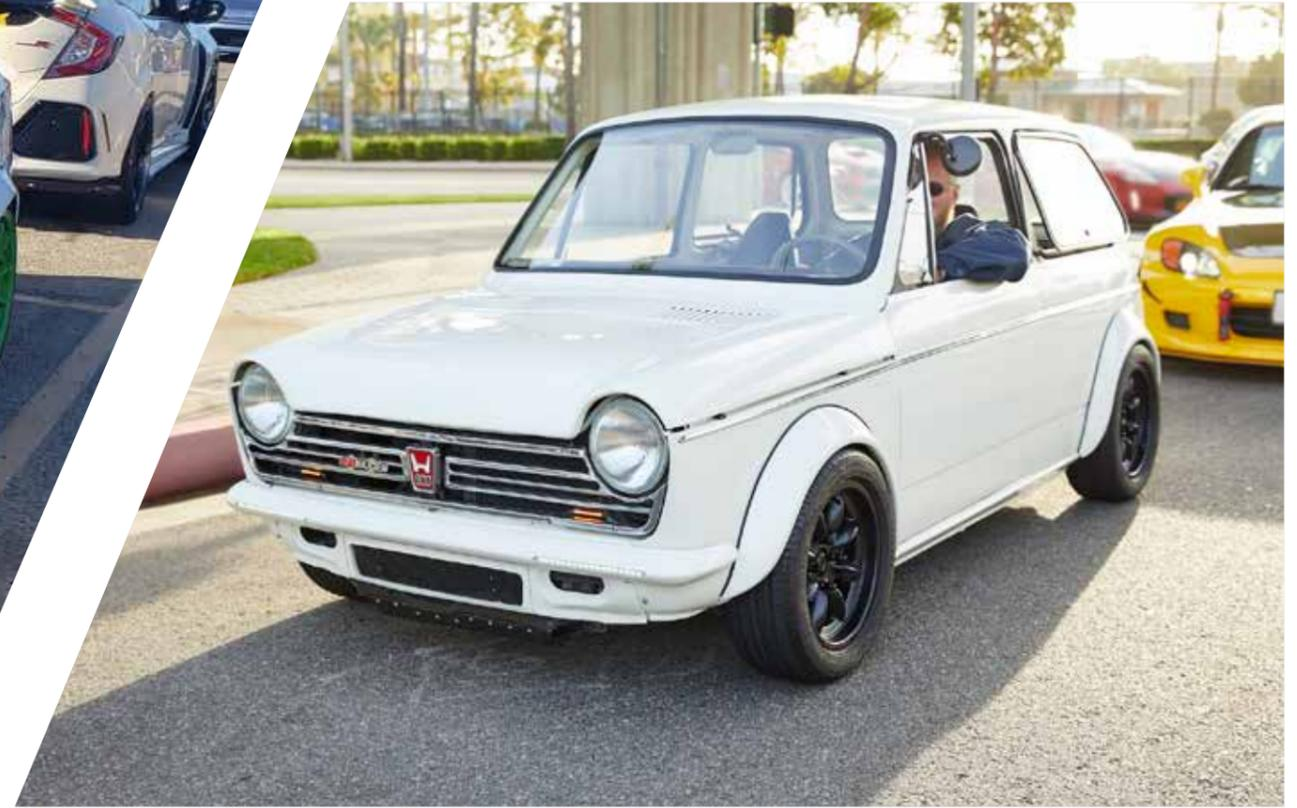
Der customized N600, verfügt über ein modifiziertes Mazda Miata-Federungssystem, Sitze aus einem Polaris RZR® und modifizierte Stoßstangen vorne und hinten aus einem 1967-68 Chevy Camaro.
