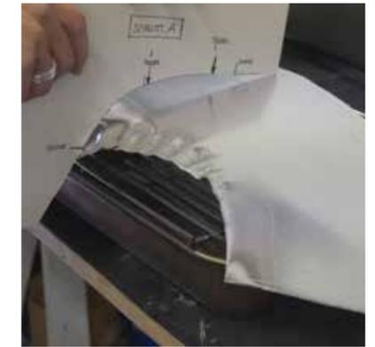
Auf einem Sandsack wird das Blech mit einem Kugelhammer in Form getrieben. Die entstandenen Unebenheiten im Blech können an einem Rundstock-Amboss mit einem Glättehammer geglättet werden. Jetzt wird zum ersten Mal die Formschablone auf das Blechteil aufgelegt und die notwendigen Linien übertragen.
