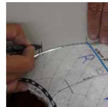
Querschnitt Masken sind für das ZTreiben der Form notwendig
