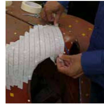
Mit Klebestreifen wird die flexible Treibschablone vorbereitet
