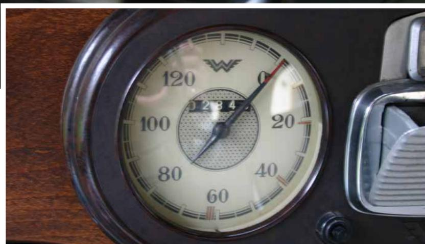
► Im Inneren des Fahrzeuges ist das Holzarmaturenbrett neu. In der Mitte sitzen auf einem Bakelit-Feld der Tacho und die Öl-druck- und Kraftstoffanzeige. Die Handbremse ist jetzt links unten im Fußraum angebracht. Das Aussteigen auf der rechten Seite des Fahrzeuges sollte so vereinfacht werden und wurde auch als Verkaufsargument genutzt.
