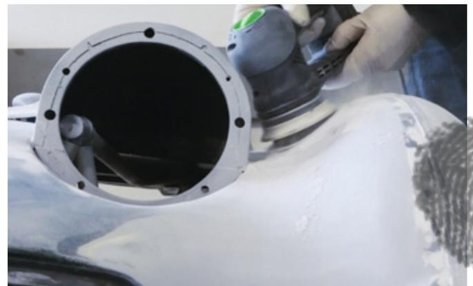
Die Spachtelarbeiten an der Motorhaube sind gut vorangekommen. Jetzt sind aber die Stellen zu schleifen, an denen mit einem Schleifgerät keine Möglichkeit besteht.
