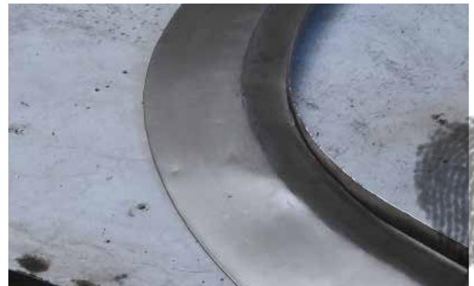
In der letzten Folge wurde die Wölbung in das Ersatzblech des Radlaufs geformt. Im nächsten Schritt wird die Kante entlang des Radausschnitts um gefalzt.
