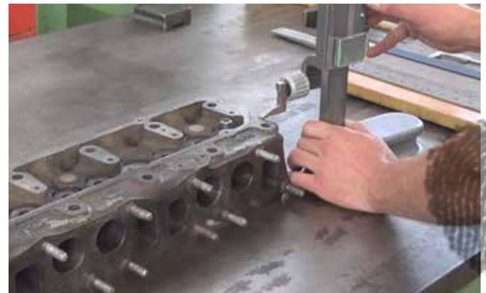
Bevor mit der eigentlichen mechanischen Überholung begonnen wird, wird zunächst einmal der Zylinderkopf gründlich gereinigt und durchgemessen.
