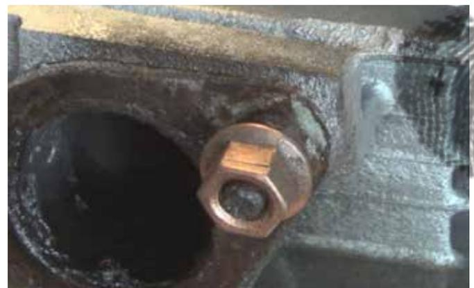
Festgerostete Gewinde-Muttern, wie zum Beispiel am uslass-Krümmer, sind, da meist stark festgerostet, in der Regel nicht mehr zu lösen. Durch den Rost haben sie sich unlösbar mit dem Metall verbunden. Daher bleibt nur, die Mutter mit einem Mutternsprenger zu sprengen.
