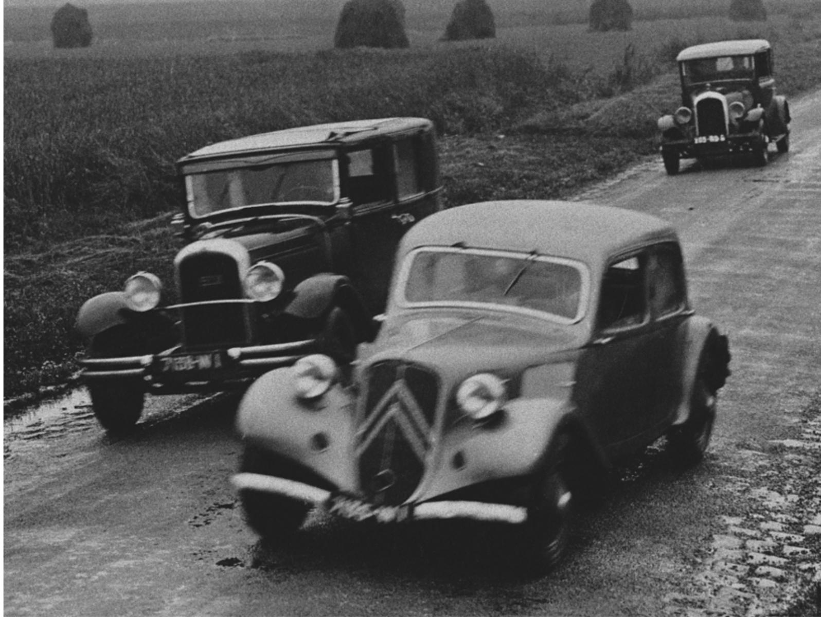
Vorgestellt wurde der Traction Avant in Paris am 18. April 1934. Und er punktete gleich mit einer hydraulischen Bremsanlage, neuen Motoren oder der Federung, außerdem brachte der Frontantrieb und die selbsttragende Karosserie mit dem tieferen Schwerpunkt das beachtlich gute Fahrverhalten, das alsbald den Ruf als sicheres, schnelles Fahrzeug begründete.
