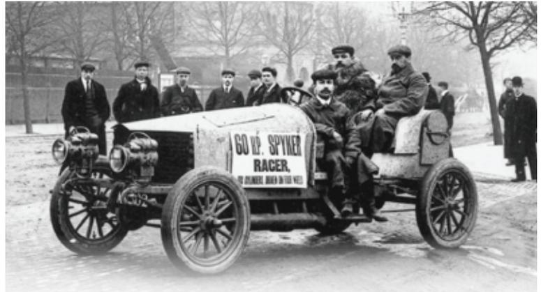
Valentin Lavolette der niederländischen Firma Spyker überrascht die Fachwelt mit dem ersten Sechszylinder-Motor und einem Vierrad-Antrieb. Der Spyker ging aber nie in die Serienproduktion.
