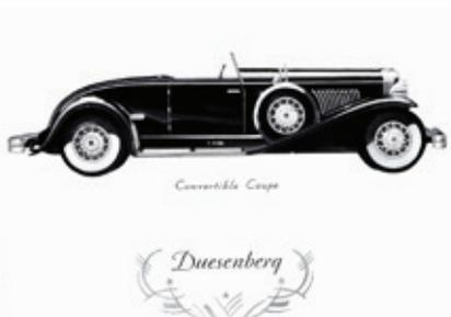
Duesenberg stellt das Model J auf den Markt. Es ist mit einer Höchstgeschwindigkeit von fast 200 km/h das schnellste US-amerikanische Fahrzeug auf dem Markt. Erreicht wird die Geschwindigkeit durch einen 6,8 Liter Reihen-Acht-Zylinder-Motor mit 265 PS.
