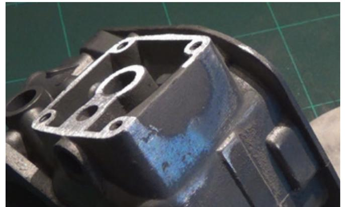
Wenn an einem Gussmetall einmal eine Ecke abgebrochen ist, kann diese mit einem Kunststoff-Metall wieder repariert werden. Solche Metal-Kunststoffe gibt es in verschiedenen Varianten, von Titankunststoff Repair Stick bis zu Stahl- und Kupfer-Massen. Die Firma Weicon bietet hier eine große Auswahl an.
