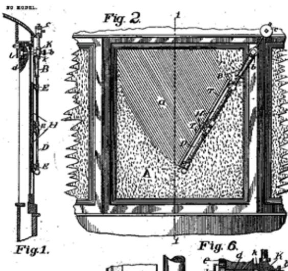
Die US-Amerikanerin Mary Anderson erhält das erste Patent auf einen funktionsfähigen Scheibenwischer. Neben dem Lenkrad ist ein kleiner Hebel angebracht mit dem sich die über eine Federmechanik gesteuerten Scheibenwischer betätigen lassen.
