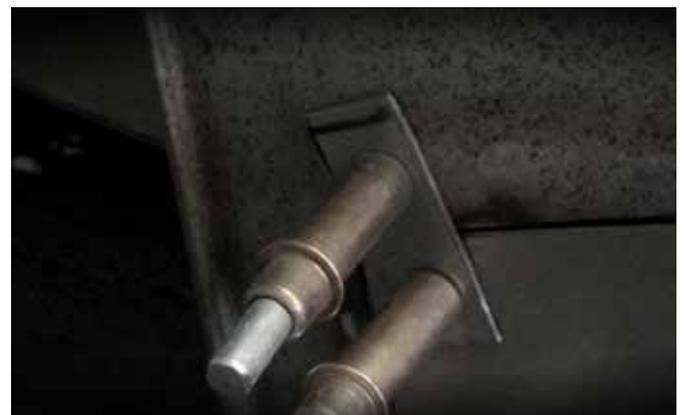
Vor dem Schweißen ist nach dem Schweißen. Je passgenauer die Ersatzbleche vor dem Schweißen fixiert sind, desto besser ist danach das Ergebnis. Sind Stellen nur schwer zugänglich für Gripzangen, kann mit einem einfachen Trick das Blech fixiert werden. Ein schmaler Blechstreifen mit einem 3mm Loch an jedem Ende schafft hier Abhilfe.
