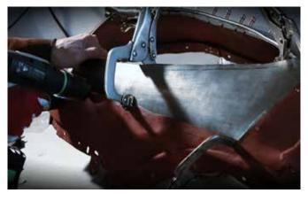
Die Kühlermaske eines mit einer Sonderkarosserie ausgestatteten Vorkriegsfahrzeug wurde Opfer des Rosts. Daher muss die Form der Maske neu aufgebaut werden. Als Basis für die Form dient eine Schablone aus Pappe. Auch die Pappe kann erst einmal mit Klemmstiften fixiert werden.
