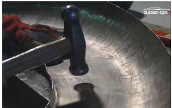
Die Kotflügelteile sind bereits geformt und nun muss noch entlang des Radlaufs das Blech umgebördelt werden. Am einfachsten geht dies mit einer lose gespannten Gripzange. Das Blech wird stückweise entlang der Markierung umgelegt.
