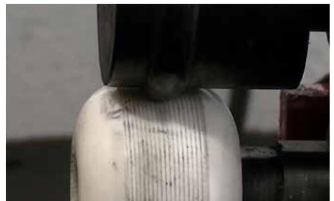
Eine weiche Skateboard-Rolle eignet sich in der Sickenrollmaschine für die Erstellung von überlappenden Sicken. Die Obere Sickenrolle presst sich in die untere Kunststoff-Rolle und ermöglicht Sicken, die mit herkömmlichen Rollen nicht zu formen sind. Verwendet man als obere Rolle eine runde Sickenrolle, wird die Sicke sehr weich, d. h. es bilden sich keine scharfen Kanten.
