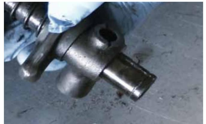
Die am stärksten beanspruchten Lager an einem Oldtimer sind Gleitlager. Zu finden sind sie in Verbrennungsmotoren, z.B. an Brems- und Kupplungspedalen, an der Ventilsteuerung und bei den Kolbenbolzen. Gleitlager sind einer extrem hohen mechanischen Beanspruchung ausgesetzt und sollten allein schon deshalb in einwandfreien Zustand sein. ...
