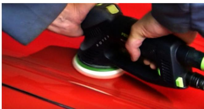
Lackkratzer auf der Oberfläche des Oldtimer Lacks sind ein Ärgernis. Daneben können sie allerdings auch in manchen Fällen dazu führen, dass der Lack an solchen Stellen schneller verwittert. Daher gilt es, solche Kratzer zu beseitigen. Zuerst wird mit einem textilen Schleifpad die Lackstelle angeschliffen. Dabei ist der Teller mit einer weichen Schleifscheibe versehen. Der Schleifteller wird auch nur einseitig über den Lack geführt.
