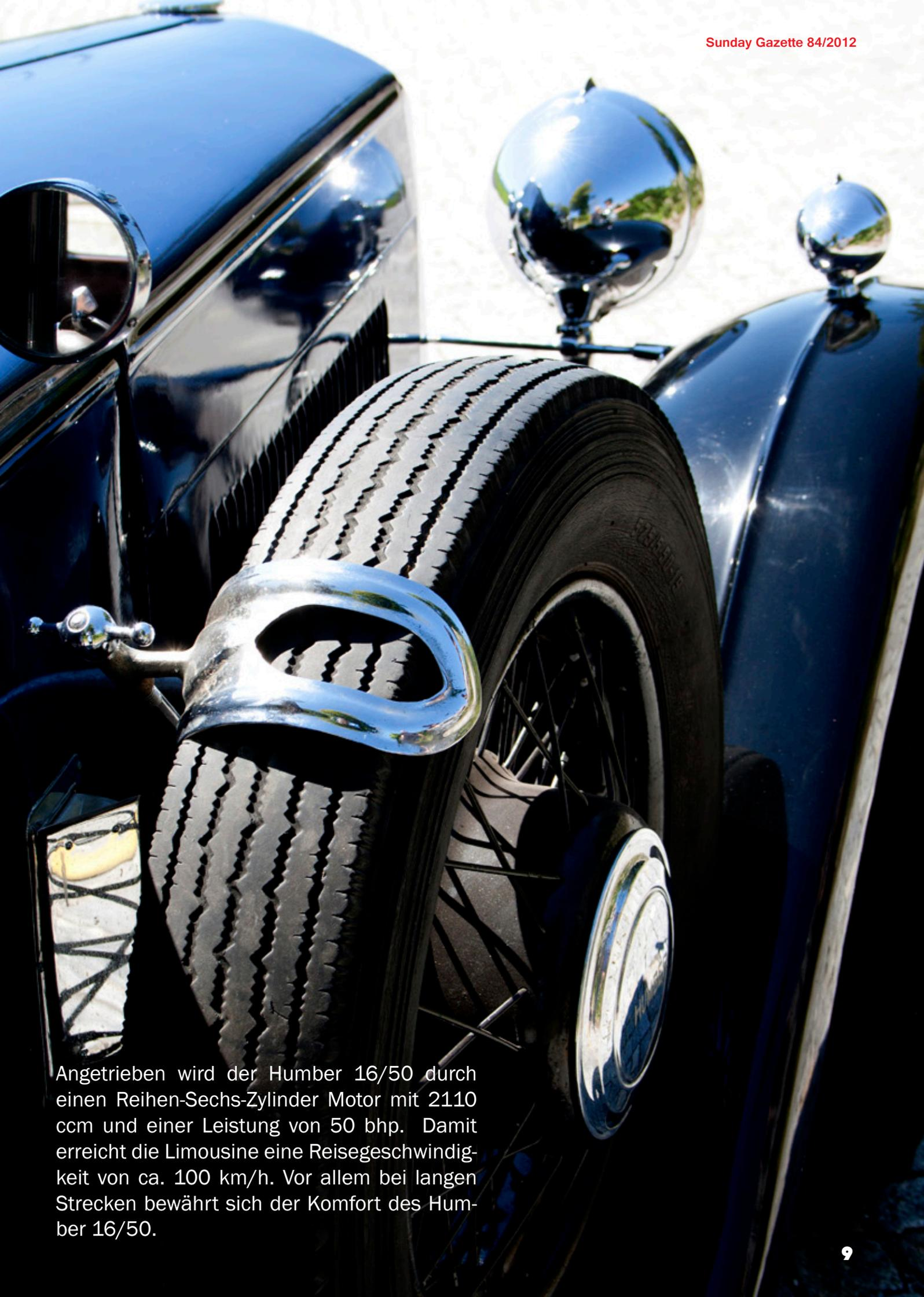
Angetrieben wird der Humber 16/50 durch einen Reihen-Sechs-Zylinder Motor mit 2110 ccm und einer Leistung von 50 bhp. Damit erreicht die Limousine eine Reisegeschwindigkeit von ca. 100 km/h. Vor allem bei langen Strecken bewährt sich der Komfort des Humber 16/50.
