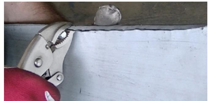
Immer wieder müssen bei Ersatzblechen die Ränder entweder abgekantet oder gebördelt werden. Der Unterschied der beiden Techniken liegt darin, dass beim Bördeln kurvenförmig geschnittene Blechkanten winkelförmig umgelegt werden, während beim Abkanten eine gerade Kante umgelegt wird. Dieser Vorgang lässt sich mit einem sehr einfach selbst konstruierten Werkzeug durchfüh-
