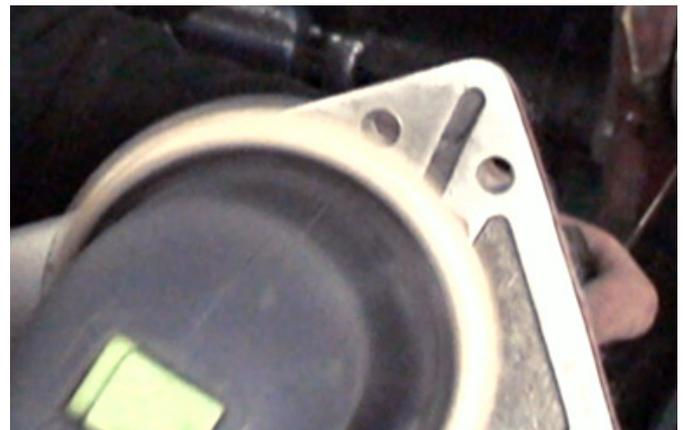
Alte Dichtflächen weisen meist Rückstände von Dichtungspapier oder Korrosion auf. Diese Rückstände müssen unbedingt beseitigt werden, damit die Dichtflächen nach dem Rückbau wieder dicht abschließen. Die einfachste Methode kleiner Dichtflächen zu planieren, ist das Abschleifen der Dichtfläche mit einem Exenterschleifer. Das verwendete Schleifpapier darf nicht zu grob sein. Am besten ist die Verwendung eines 250er oder 400er Schleifpapier.
