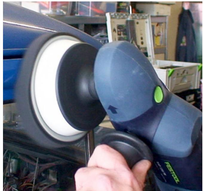
Spachtelmasse durchgehend ausgehärtet, kann mit feinem Schleifpapier die Stelle glatt geschliffen werden. Das Schleifen muss trocken erfolgen, denn Polyester-spachtel ist hydrostatisch und saugt das Wasser ein. Dies ist für die anschließende Lackierung sehr ungünstig, da der Lack an dieser Stelle nicht mit dem Untergrund bindet und Blasen bildet.
