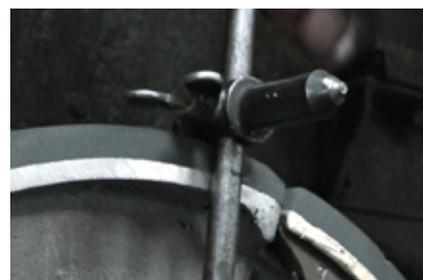
Eine einfache Methode die Backen zu zentrieren ist ein Kugellager mit einer aufgeschweißten Einstell-Achse an dessen Ende sich eine Schraube mit einem Stift befindet. Eine solche
