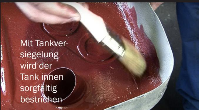
Mit Tankversiegelung wird der Tank innen sorgfältig bestrichen
