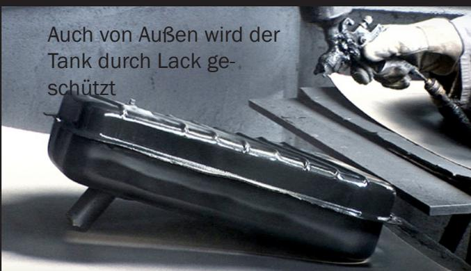
Auch von Außen wird der Tank durch Lack geschützt
